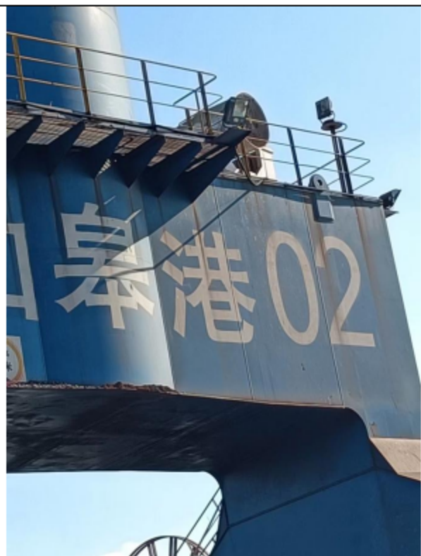
门座起重机上抑尘雾炮系统
